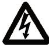
Warnung vor gefährlicher elektrischer Spannung
