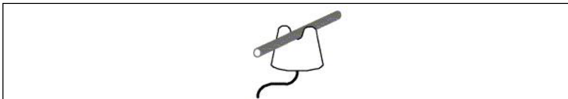
Abbildung 5.24 - Verlegearten für elektrische Leitungen - Auf Isolatoren
