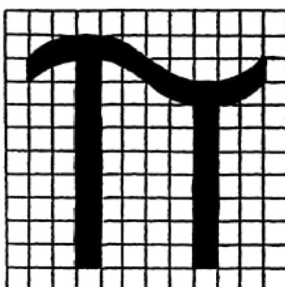
2. De pi-markering moet minstens 5 mm hoog zijn en minstens 2,5 mm hoog voor vervoerbare drukapparatuur met een diameter van maximaal 140 mm.
