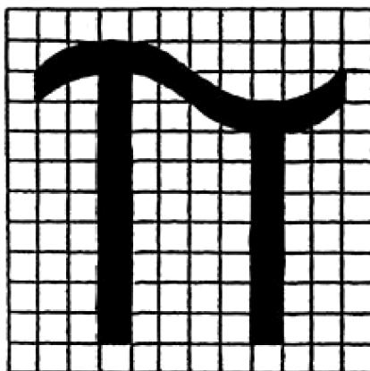
2. Le marquage Pi a une hauteur minimale de 5 mm. Pour les équipements sous pression transportables dont le diamètre n'excède pas 140 mm, la hauteur minimale est de 2,5 mm.
