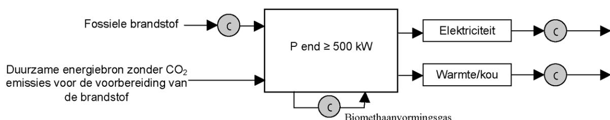
Er zijn minstens 4 meet- en telapparatu ren : telling van de hoeveelheid verbruikte hernieuwbare brandstof, telling van de netto geproduceerde elektrische energie, in voorkomend geval telling van de werkelijk gevaloriseerde netto calorische energie en telling van werkingsuren.
