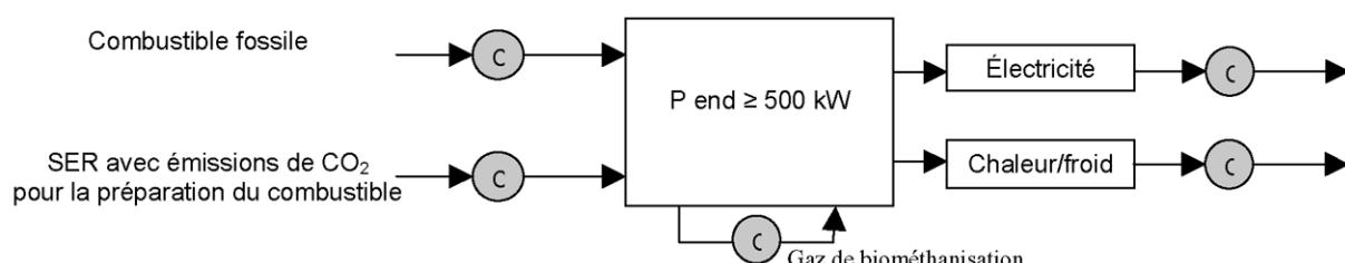
Les installations de mesure et de comptage sont au minimum au nombre de 4 : comptage de la quantité de combustible renouvelable consommé, comptage de l'énergie électrique nette produite, comptage le cas échéant de l'énergie calorifique nette réellement valorisée, et comptage d'heures de fonctionnement. En cas d'utilisation d'un combustible fossile supplémentaire, une installation de mesure et de comptage supplémentaire devra être prévue.
