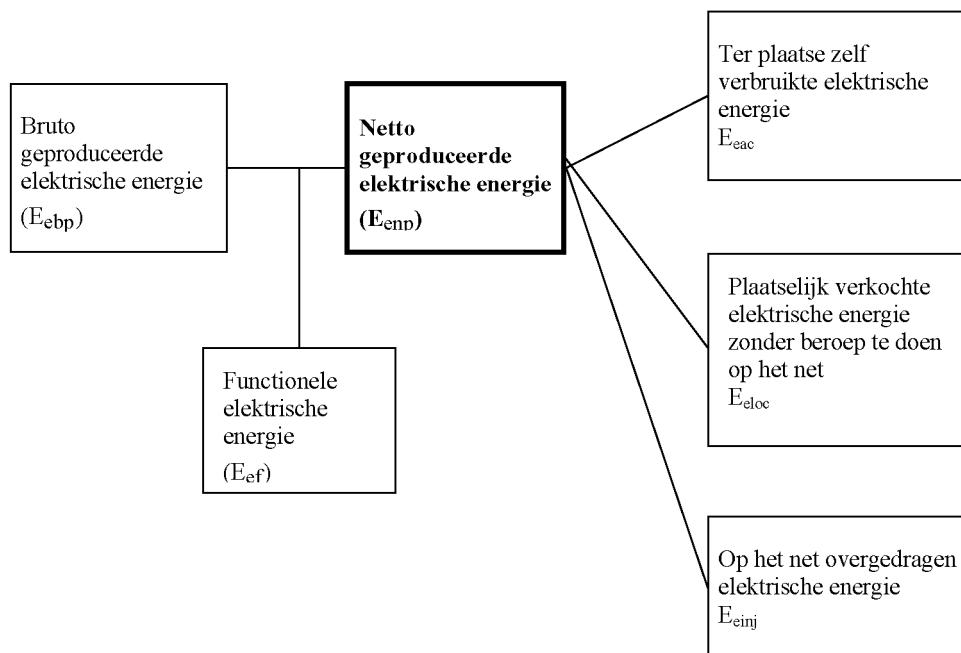
De bruto geproduceerde elektrische energie ( $E_{ebp}$ ) is de totale energie die door de productie-eenheid geproduceerd wordt; die energie omvat dus de functionele elektrische energie ( $E_{ef}$ ), die ter plaatse door de groene producent ( $E_{eac}$ ) zelf verbruikt wordt en de op het netwerk ( $E_{einj}$ ) overgedragen energie, en, desgevallend, de plaatselijk verkochte elektrische energie zonder beroep te doen op het net ( $E_{eloc}$ ).
