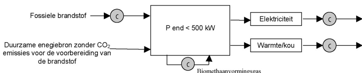
Er zijn minstens 4 meet- en telapparaturen : berekening van de hoeveelheid verbruikte fossiele brandstof, berekening van de netto geproduceerde elektrische energie, in voorkomend geval telling van de werkelijk gevaloriseerde netto calorische energie en telling van werkingsuren.
