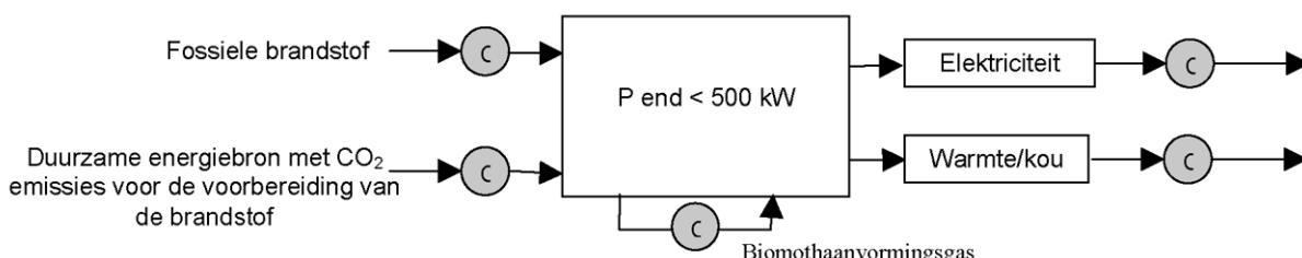
Er zijn minstens 4 meet- en telapparatu ren : telling van de hoeveelheid verbruikte hernieuwbare brandstof, telling van de netto geproduceerde elektrische energie, telling, in voorkomend geval, van de werkelijk gevaloriseerde netto calorische energie en telling van werkingsuren. Bij gebruik van een aanvullende fossiele brandstof wordt voorzien in een aanvullende meet- en telapparatuur.
