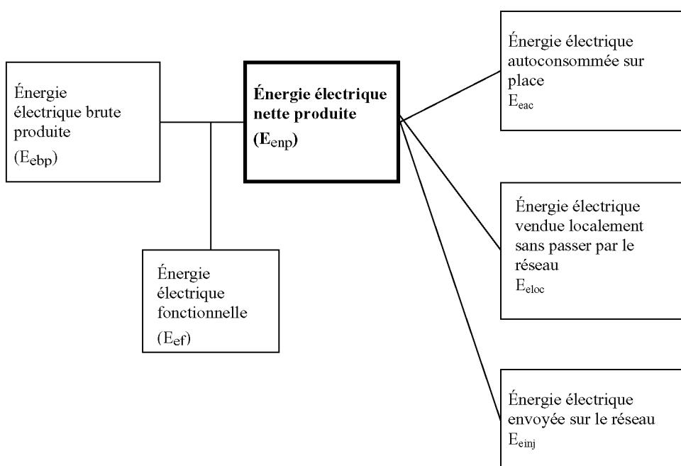
L'énergie électrique brute produite ( $E_{\text{ebp}}$ ) est l'énergie totale produite par l'unité de production; cette énergie comprend donc l'énergie électrique fonctionnelle ( $E_{\text{ef}}$ ), l'énergie électrique autoconsommée sur place par le producteur vert ( $E_{\text{eac}}$ ), l'énergie électrique envoyée sur le réseau ( $E_{\text{einj}}$ ), et, le cas échéant, l'énergie électrique vendue localement sans passer par le réseau ( $E_{\text{eloc}}$ ).
