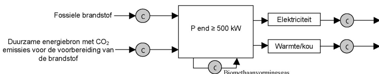
Er zijn minstens 4 meet- en telapparatuuren : telling van de hoeveelheid verbruikte hernieuwbare brandstof, telling van de netto geproduceerde elektrische energie, telling, in voorkomend geval, van de werkelijk gevaloriseerde netto calorische energie en telling van werkingsuren. Bij gebruik van een aanvullende fossiele brandstof wordt voorzien in een aanvullende meet- en telapparatuur.
