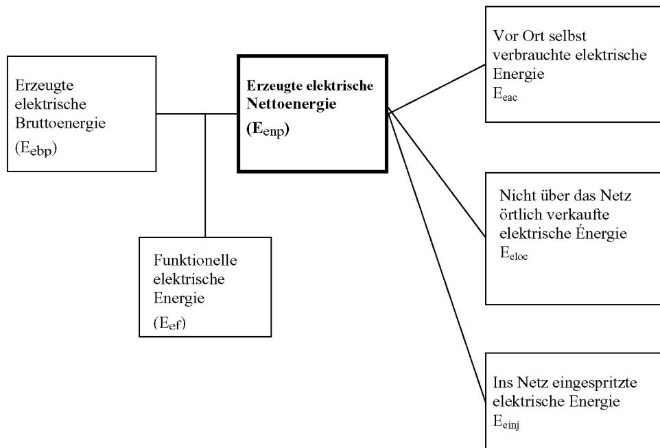
Die erzeugte elektrische Bruttoenergie ( $E_{ebp}$ ) ist die gesamte durch die Erzeugungseinheit erzeugte Energie; diese Energie enthält also die funktionelle elektrische Energie ( $E_{ef}$ ), die am Standort zu eigenen Zwecken vom Grünstromerzeuger verbrauchte elektrische Energie ( $E_{eac}$ ), die in das Netzwerk eingespeiste elektrische Energie ( $E_{einj}$ ) und ggf. die vor Ort, nicht über das Netzwerk verkauft elektrische Energie ( $E_{eloc}$ ).
