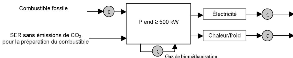
Les installations de mesure et de comptage sont au minimum au nombre de 4 : comptage de la quantité de combustible fossile consommé, comptage de l'énergie électrique nette produite, comptage le cas échéant de l'énergie calorifique nette réellement valorisée, et comptage d'heures de fonctionnement.
