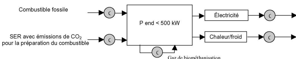
Les installations de mesure et de comptage sont au minimum au nombre de 4 : comptage de la quantité de combustible renouvelable consommé, comptage de l'énergie électrique nette produite, comptage le cas échéant de l'énergie calorifique nette réellement valorisée, et comptage d'heures de fonctionnement. En cas d'utilisation d'un combustible fossile supplémentaire, une installation de mesure et de comptage supplémentaire devra être prévue.
