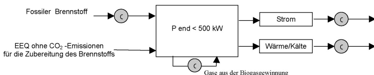
\*Die Mess- und Zählvorrichtungen sind mindestens 4 in der Anzahl : Zählung der Menge des verbrauchten fossilen Brennstoffs, Zählung der erzeugten elektrischen Nettoenergie, gegebenenfalls, Zählung der tatsächlich verwerteten thermischen Nettoenergie und Zählung der Betriebsstunden.
