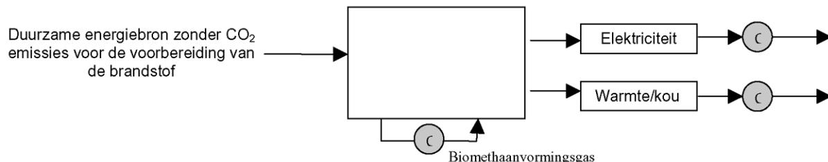
Er zijn minstens 3 meet- en telapparaturen : telling van de netto geproduceerde elektrische energie, in voorkomend geval telling van de werkelijk gevaloriseerde netto calorische energie en berekening van werkingsuren.
