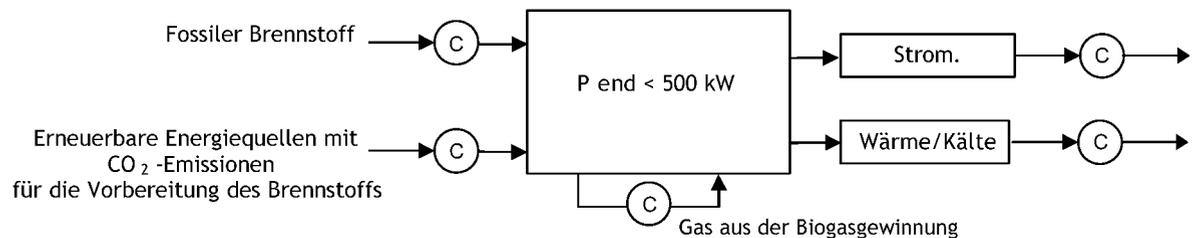
Die Mess- und Zählvorrichtungen sind mindestens 4 in der Anzahl: Zählung der Menge des verbrauchten erneuerbaren Brennstoffs, Zählung der erzeugten elektrischen Nettoenergie, gegebenenfalls, Zählung der tatsächlich verwerteten thermischen Nettoenergie und Zählung der Betriebsstunden. Bei Verwendung eines zusätzlichen fossilen Brennstoffs wird man eine zusätzliche Mess- und Zählvorrichtung vorsehen müssen.
