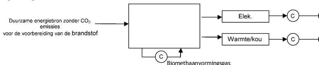
Er zijn minstens 3 meet- en telapparaturen : telling van de netto geproduceerde elektrische energie, in voorkomend geval telling van de werkelijk gevaloriseerde netto calorische energie en berekening van werkingsuren.
