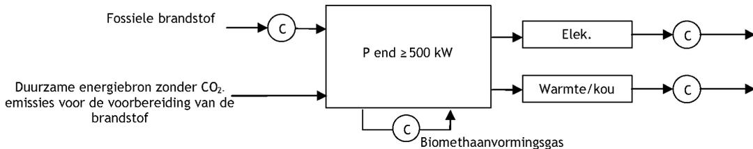
Er zijn minstens 4 meet- en telapparaturen : telling van de hoeveelheid verbruikte hernieuwbare brandstof, telling van de netto geproduceerde elektrische energie, in voorkomend geval telling van de werkelijk gevaloriseerde netto calorische energie en telling van werkingsuren. In deze categorie is de telling van de hernieuwbare brandstof niet nodig, behalve in geval van biomethaanvormingsgas waarvan de telling in alle gevallen voorzien wordt.
