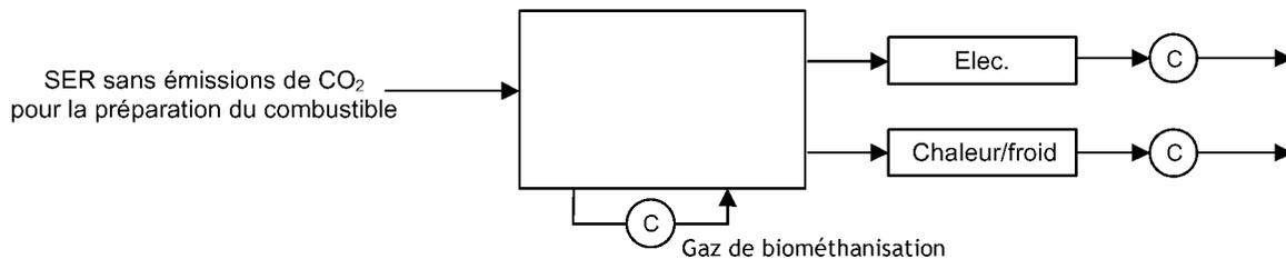
Les installations de mesure et de comptage sont au minimum au nombre de 3 : comptage de l'énergie électrique nette produite, comptage le cas échéant de l'énergie calorifique nette réellement valorisée, et comptage d'heures de fonctionnement.
