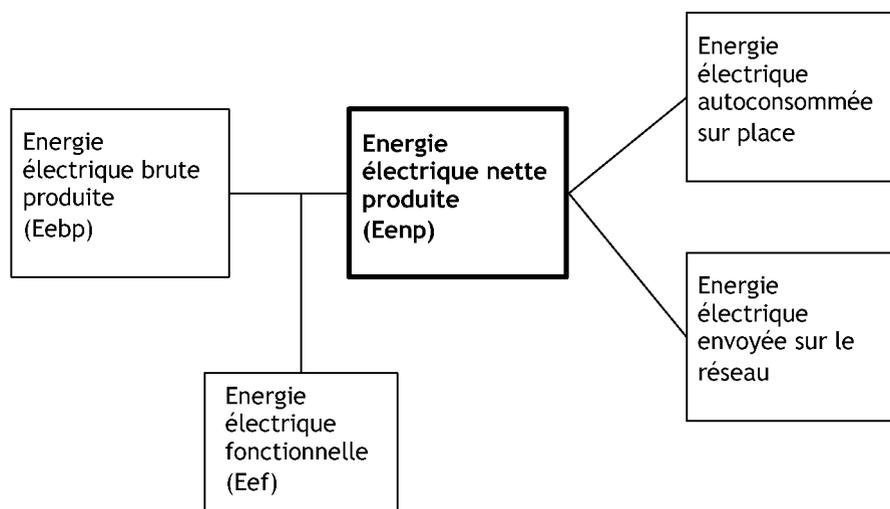
L'énergie électrique brute produite (Eebp) est l'énergie totale produite par l'unité de production; cette énergie comprend donc l'énergie électrique fonctionnelle (Eef), l'énergie électrique autoconsommée sur place par le producteur vert, et l'énergie électrique envoyée sur le réseau.
