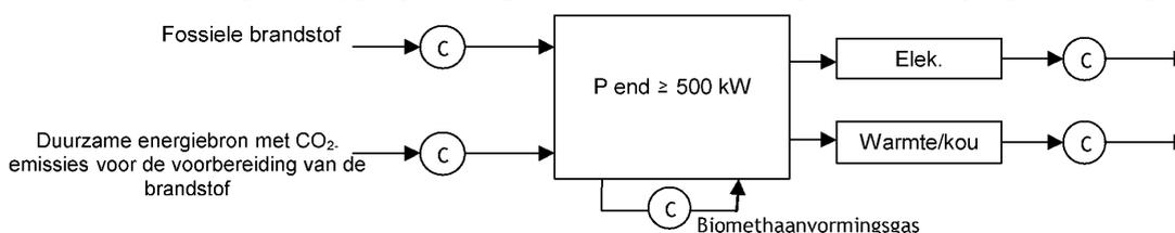
Er zijn minstens 4 meet- en telapparaturen : telling van de hoeveelheid verbruikte hernieuwbare brandstof, telling van de netto geproduceerde elektrische energie, in voorkomend geval telling van de werkelijk gevaloriseerde netto calorische energie en telling van werkingsuren. Bij gebruik van een aanvullende fossiele brandstof wordt voorzien in een aanvullende meet- en telapparatuur.
