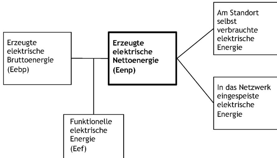
Die erzeugte elektrische Bruttoenergie (Eebp) ist die gesamte durch die Erzeugungseinheit erzeugte Energie; diese Energie enthält also die funktionelle elektrische Energie (Eef), die am Standort zu eigenen Zwecken vom Grünstromerzeuger verbrauchte elektrische Energie und die in das Netzwerk eingespeiste elektrische Energie.
