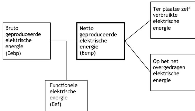
De bruto geproduceerde elektrische energie (Eebp) is de totale energie die door de productie-eenheid geproduceerd wordt; die energie omvat dus de functionele elektrische energie (Eef), die ter plaatse door de groene producent zelf verbruikt wordt en de op het netwerk overgedragen energie.
